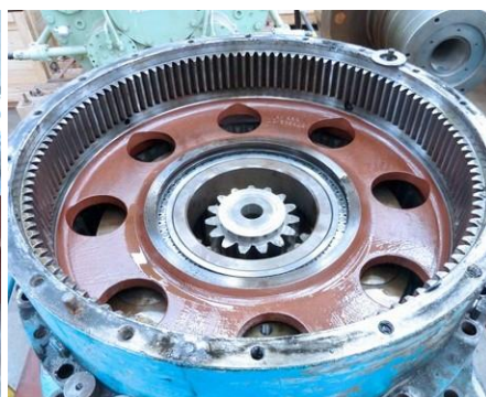
Recondicionamento de redutor planetário no Centro de Serviço da Austrália
