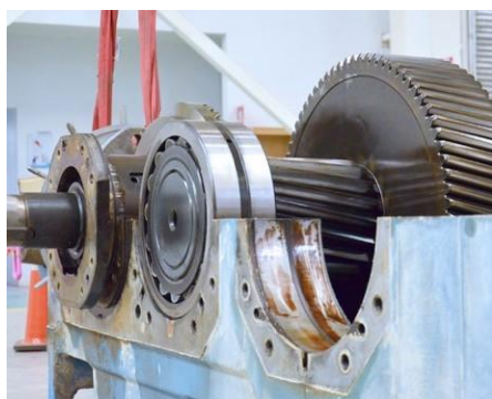
Recondicionamento de redutores de engrenagens helicoidais no Centro de Serviços do Chile
