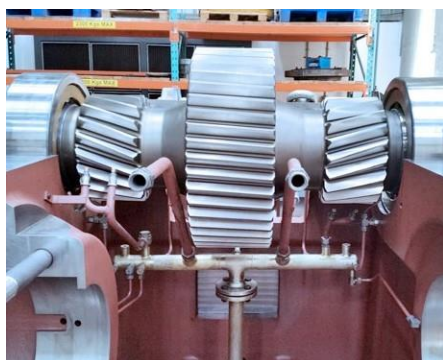
Recondicionamento de redutor Combiflex no Centro de Serviços da África do Sul
